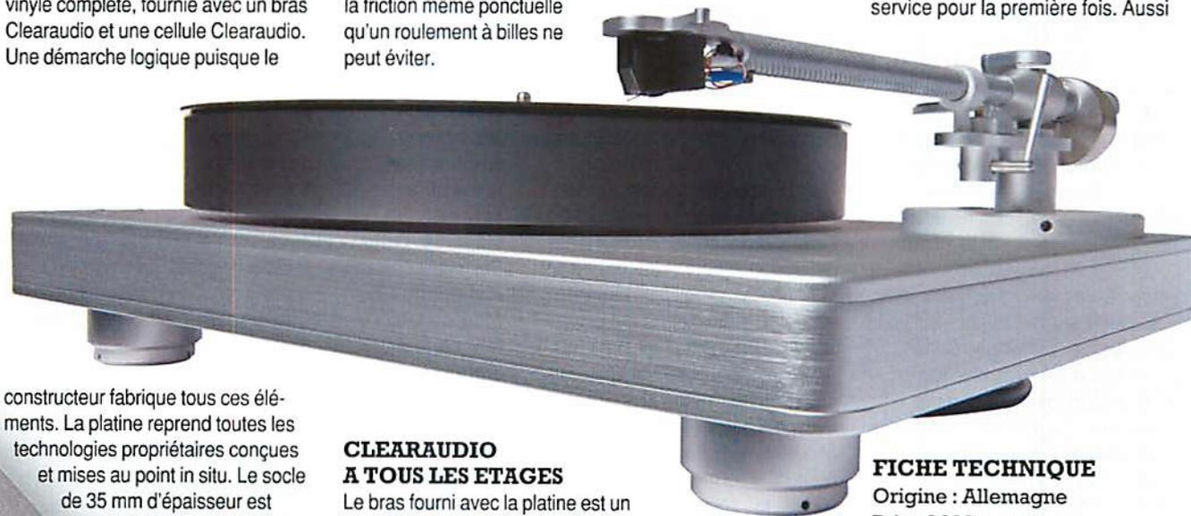
constructeur fabrique tous ces éléments. La platine reprend toutes les technologies propriétaires conçues et mises au point in situ. Le socle de 35 mm d'épaisseur est un sandwich de médium très dense entre deux plaques d'aluminium de 5 mm. Il a été optimisé en termes d'absence de propagation des réso-
